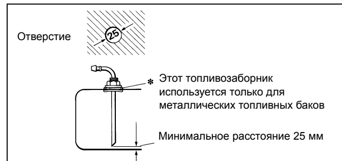
Рис.11: Топливозаборник Webasto из бака
